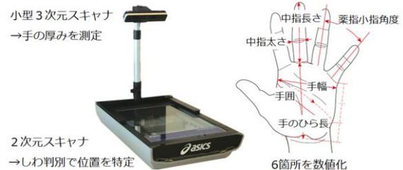
Fig.1 手型計測装置
