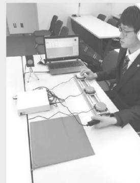
反応時間測定システム
