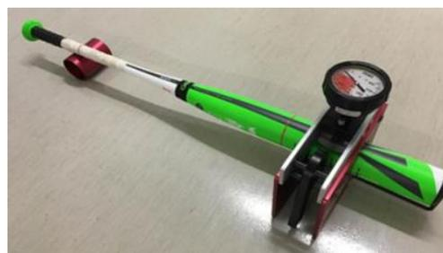
図 1 小型のバレル部圧縮試験機
