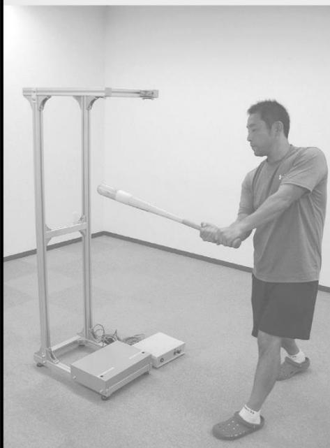
2区間のセンサをバットで横切った時間の差によりスイングスピードを測定します。
