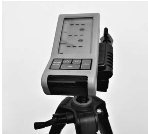
図1 本実験で用いたマイクロ波センサー式スピード計測器
