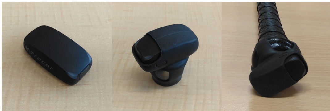
図5 簡易型スイング特性分析器 (左：分析器本体, 中央：専用アタッチメント装着時, 右：バット装着時)
